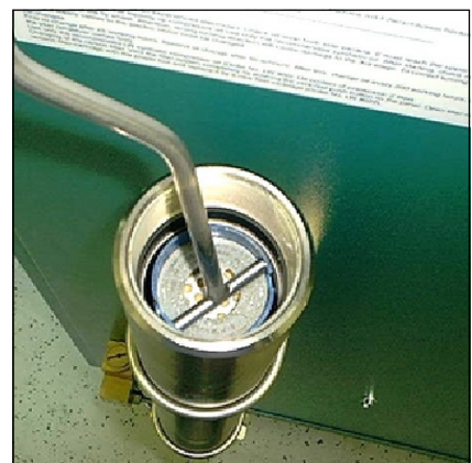
Abb. 2 - T-Stück Ende des Filter-Schlüssels in die Aussparungen legen
