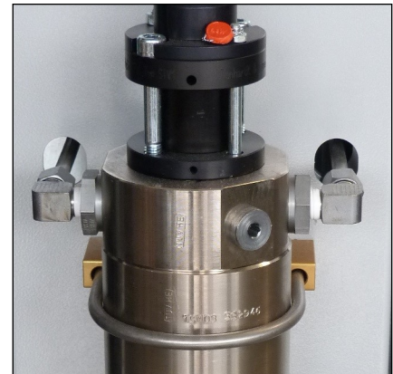
Abb. 1 - Rohrleitungsverschraubungen und Muttern lösen
