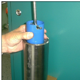
Abb. 4 - Filterpatrone aus dem Gehäuse entnehmen
