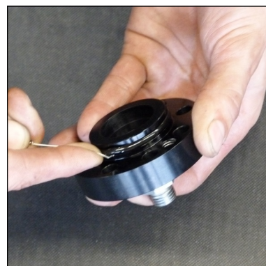
Abb. 4 - O-Ring wechseln (Deckel Kondensat-Stopp-Ventil)
