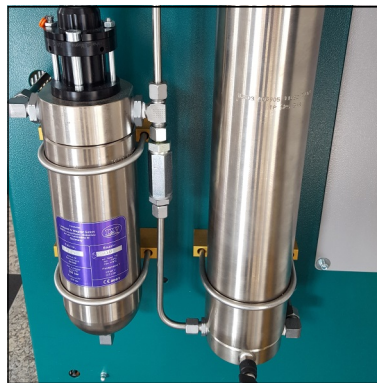
Abb. 3 - Rohrleitungsver-schraubungen und Muttern lösen
