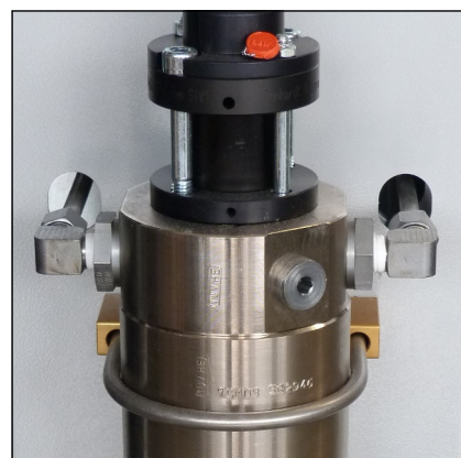
Abb. 1 - Rohrleitungen und Muttern lösen
