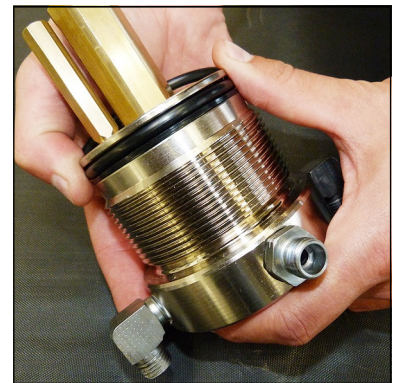
Abb. 4 - O-Ring und Stützring wechseln
