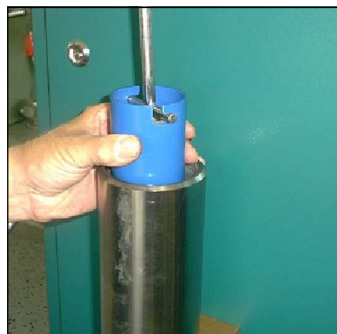
Abb. 4 - Filterpatrone aus dem Gehäuse entnehmen
