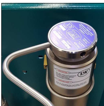
Abb. 2 - Abschrauben des Filtergehäuse-Deckels
