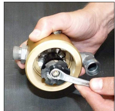
Abb. 2 - Mutter am Oberteil lösen
