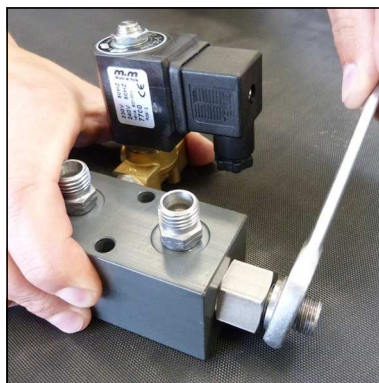
Abb. 2 - Gerade Verschraubung lösen
