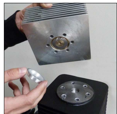
Abb. 2 - Untere Ventildichtung entfernen
