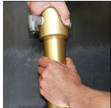
Abb. 1 - Oberteil abschrauben und abnehmen
