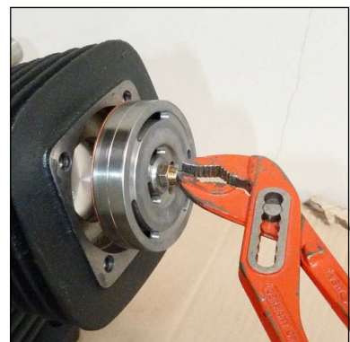
Abb. 2 - Saug- / Druckventil herausziehen
