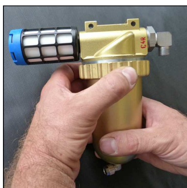
Fig. 1 - Loosen ring nut
