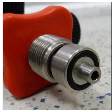
Abb. 1 - O-Ring am Füllventil
