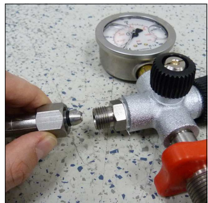
Abb. 2 - O-Ring am Füllschlauch
