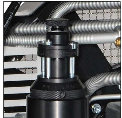
Abb. 1 - Filterdeckel abdrehen/ eindreihen
