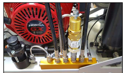
Abb. Druckminderer: 330 / 225 bar
