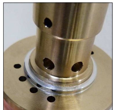
Abb. 5 - Auf korrekte Einbauposition des oberen Ventildichtrings achten
