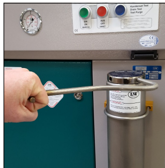
Abb. 2 - Abschrauben des Filtergehäuse-Deckels
