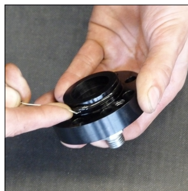
Abb. 4 - O-Ring wechseln (Deckel Kondensat-Stopp-Ventil)
