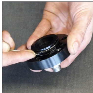
Abb. 4 - O-Ring wechseln (Deckel Kondensat-Stopp-Ventil)
