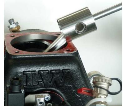
Abb. 2 - Kolben 3. Stufe
