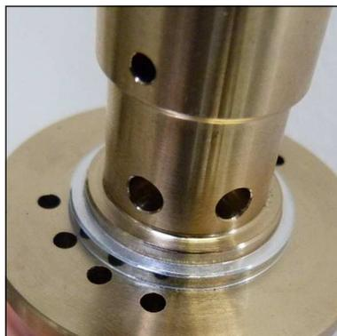
Abb. 4 - Auf korrekte Einbauposition des oberen Ventildichtrings achten
