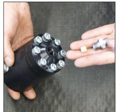
Abb. 5 - Sinterfilter wechseln
