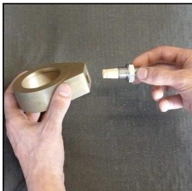
Abb. 7 - Sinterfilter wechseln
