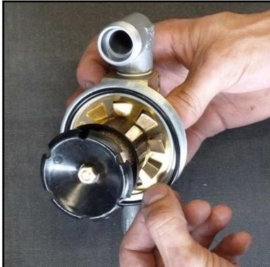
Abb. 4 - O-Ring wechseln
