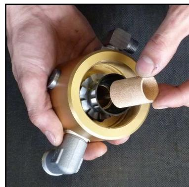
Abb. 3 - Sinterfilter wechseln
