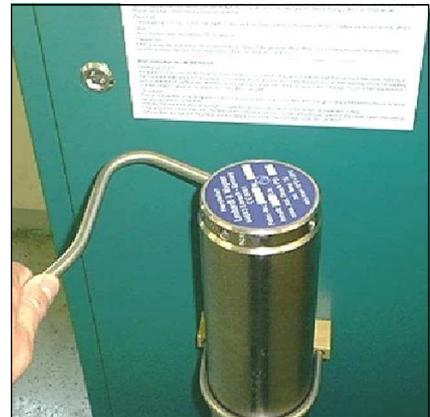
Abb. 1 - Abschrauben des Filtergehäuse-Deckels
