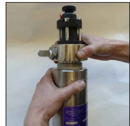
Abb. 3 - Filterdeckel öffnen
