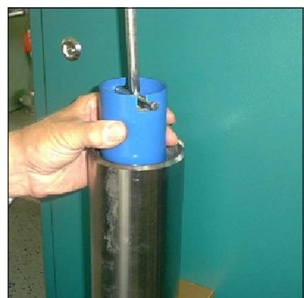
Abb. 2 - Filterpatrone aus dem Gehäuse ziehen
