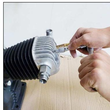
Abb. 1 - Ventilkopfschrauben lösen
