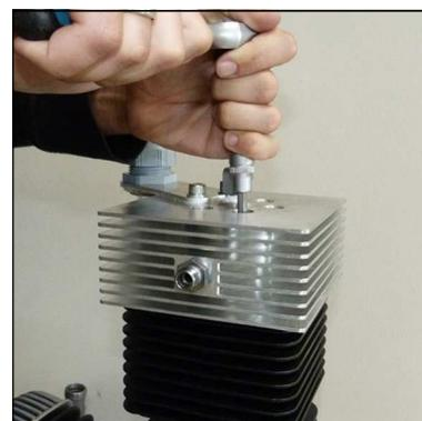
Abb. 1 - Ventilkopfschrauben lösen
