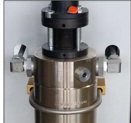
Abb. 1 - Rohrleitungsverschraubungen und Muttern lösen
