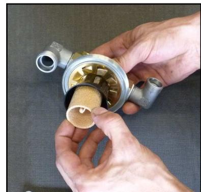
Abb. 3 - Sinterfilter wechseln
