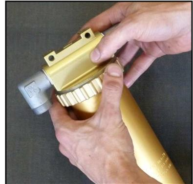
Abb. 1 - Gewinding öffnen und Oberteil abnehmen
