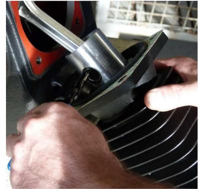
Abb. 1 - Kolbenmontage
