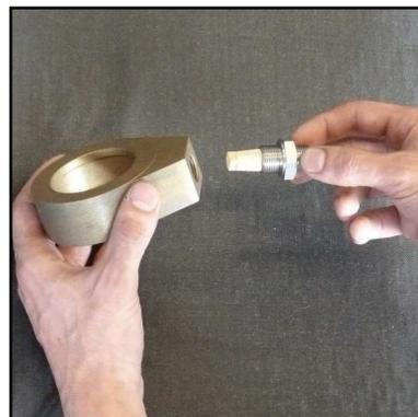
Abb. 8 - Sinterfilter wechseln
