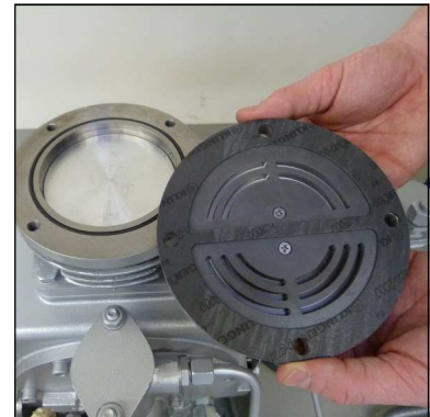
Abb. 2 - Einbauposition der oberen Ventildichtung
