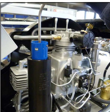
Abb. 2 - Filterpatrone mit Filterschlüssel entnehmen
