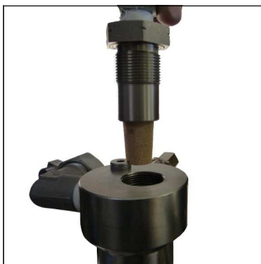
Abb. 2 - Halter für Sinterfilter entnehmen
