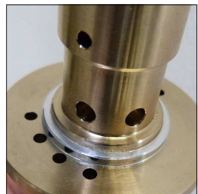
Abb. 5 - Auf korrekte Einbauposition des oberen Ventildichtrings achten
