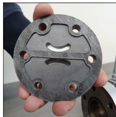
Abb. 2 - Einbauposition der oberen Ventildichtung
