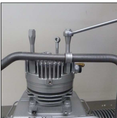
Abb. 5 - Obere Kühlrohrhalterung entfernen
