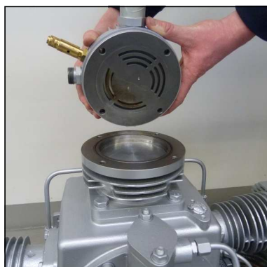
Abb. 3 - Einbauposition der Ventilplatte mit Ventilkopf
