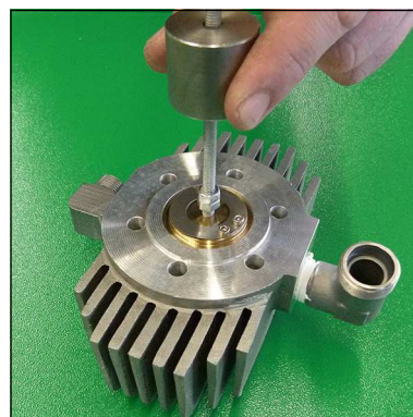
Abb. 4 - Saug / Druckventil ausbauen
