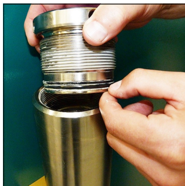
Abb. 2 - O-Ring und Stützring wechseln
