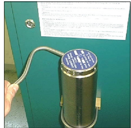
Abb. 1 - Abschrauben des Filtergehäuse-Deckels
