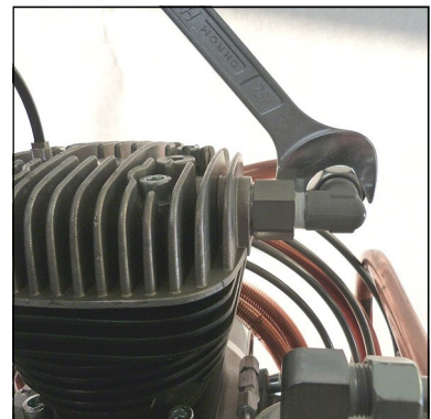
Abb. 6 - Rohrleitungsverschraubung anschließen und anziehen
