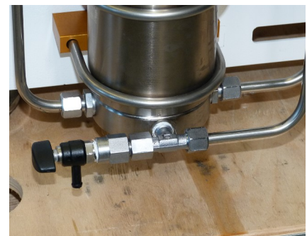
Abb. 2 - Kondensatablasshahn am Filtergehäuse
