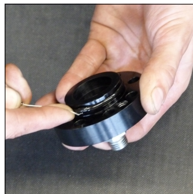
Abb. 4 - O-Ring wechseln (Deckel Kondensat-Stopp-Ventil)
