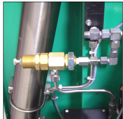
Abb. Druckminderer: 330 / 225 bar
