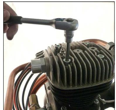
Abb. 5 - Ventilkopfschrauben eindrehen
