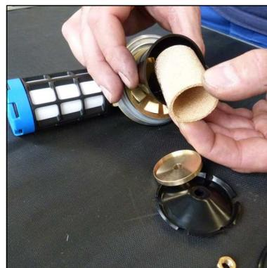
Abb. 2 - Sinterfilter wechseln
