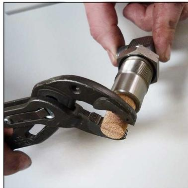
Abb. 3 - Sinterfilter wechseln
