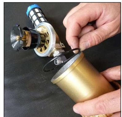
Abb. 3 - O-Ring wechseln
