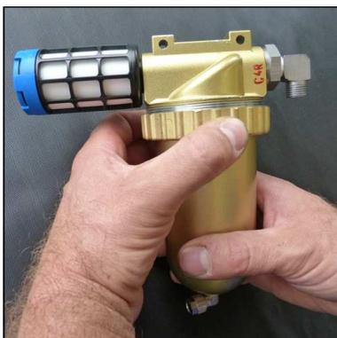
Abb. 1 - Gewinding lösen
