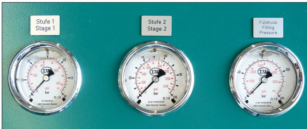
Die angezeigten Zwischendrucke sind vom eingestellten Enddruck abhängig.
