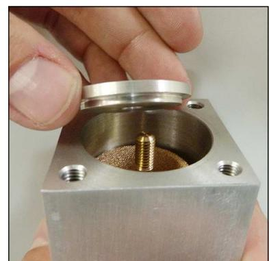
Abb. 5 - Filterscheibe und Unterlegscheibe aufsetzen
