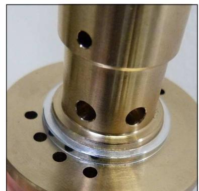
Abb. 5 - Auf korrekte Einbauposition des oberen Ventildichtrings achten
