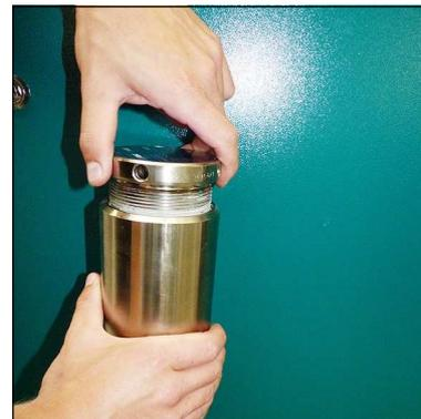
Abb. 1 - Filterdeckel öffnen
