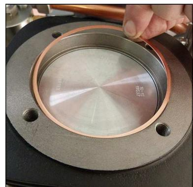
Abb. 3 - Kupfer-Ventildichtung
