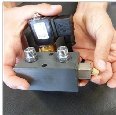
Abb. 3 - Sinterfilter wechseln
