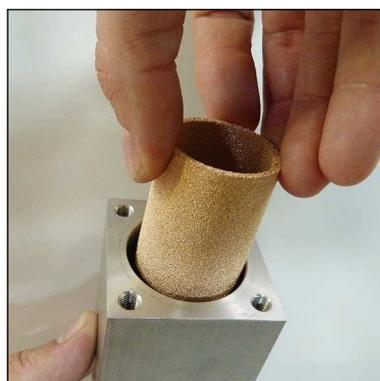
Abb. 4 - Sinterfilter wechseln
