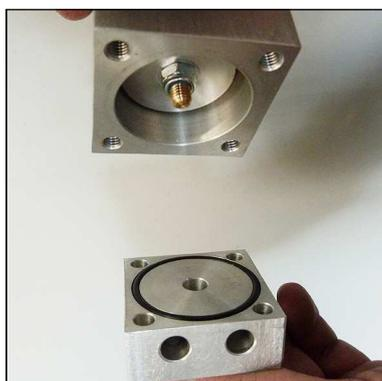
Abb. 3 - O-Ring wechseln
