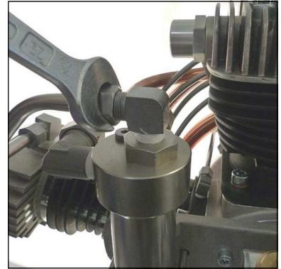
Abb. 1 - Rohrleitungsverschraubungen lösen
