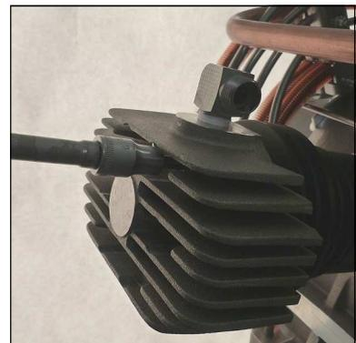
Abb. 2 - Ventilkopfschrauben lösen
