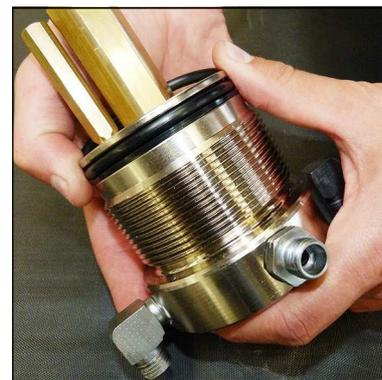
Abb. 4 - O-Ring und Stützring wechseln
