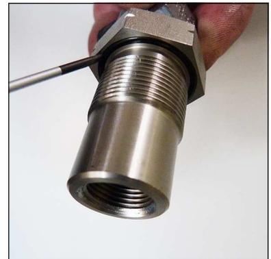
Abb. 4 - O-Ring wechseln
