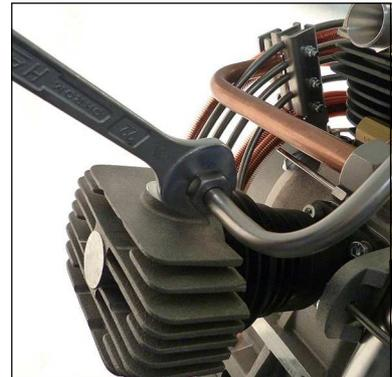
Abb. 1 - Rohrleitungsverschraubungen lösen
