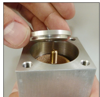
Abb. 5 - Filterscheibe und Unterlegscheibe aufsetzen
