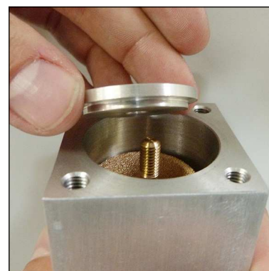
Abb. 5 - Filterscheibe und Unterlegscheibe aufsetzen
