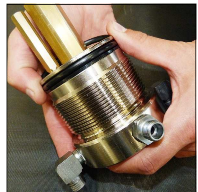
Abb. 4 - O-Ring und Stützring wechseln
