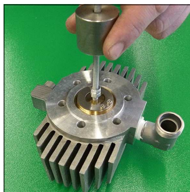
Abb. 4 - Saug / Druckventil ausbauen
