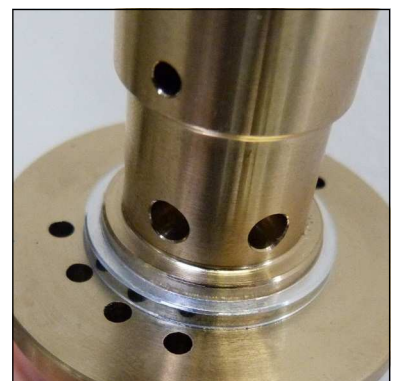
Abb. 5 - Auf korrekte Einbauposition des oberen Ventildichtrings achten
