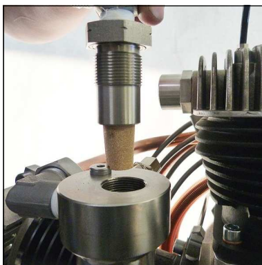
Abb. 2 - Halter für Sinterfilter entnehmen
