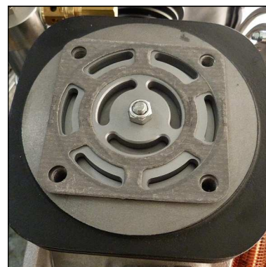
Abb. 4 - Obere Ventildichtung ausgerichtet auflegen
