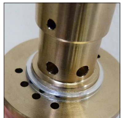
Abb. 5 - Auf korrekte Einbauposition des oberen Ventildichtrings achten
