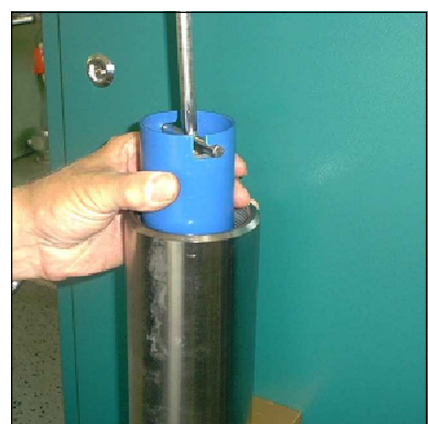
Abb. 3 - Filterpatrone aus dem Gehäuse ziehen
