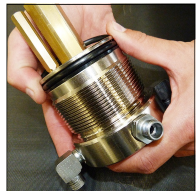
Abb. 4 - O-Ring und Stützring wechseln
