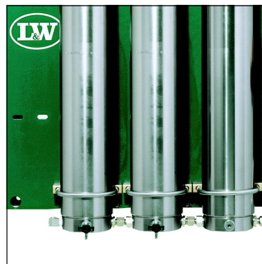
Abb. 3 - Rohrleitungsverschraubungen und Muttern lösen
