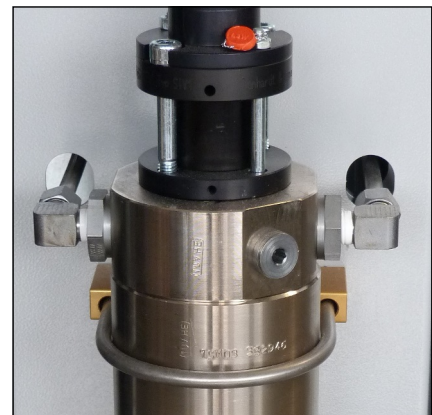
Abb. 1 - Rohrleitungsverraubungen und Muttern lösen
