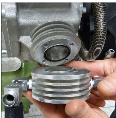
Abb. 3 - Ventilkopf mit Saug- und Druckventil entnehmen
