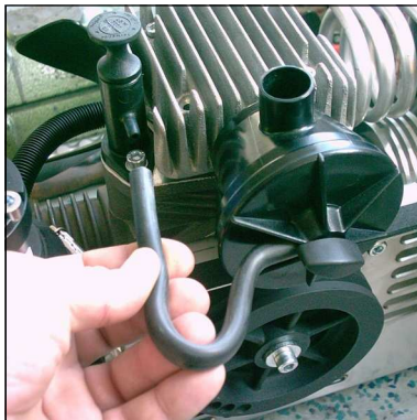
Abb. 1 - Entlüftungsschlauch am Öleinfüllstutzen abziehen
