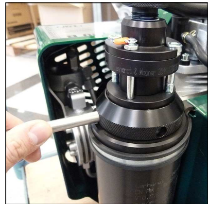
Abb. 1 - Filtergehäusedeckel mit Filterschlüssel öffnen
