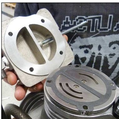
Abb. 7 - Ein- und Auslasskanäle müssen genau zentriert sein
