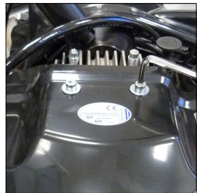
Abb. 1 - Befestigungsschrauben der Ventilator-Schutzabdeckung lösen
