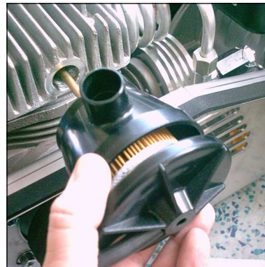
Abb. 2 - Filtergehäuse vorsichtig herausziehen
