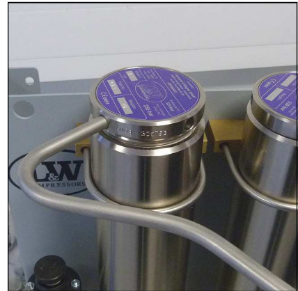
Abb. 1 - Abschrauben des Filtergehäuse-Deckels
