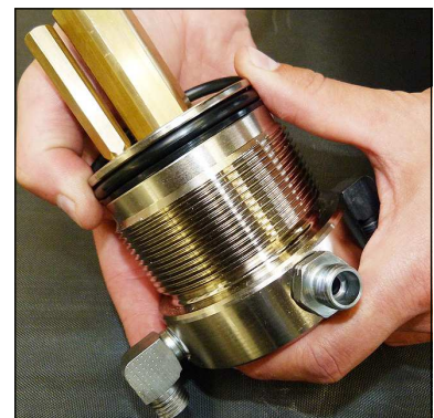
Abb. 4 - O-Ring und Stützring wechseln
