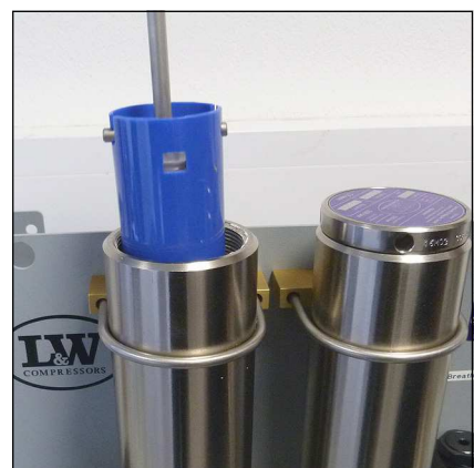
Abb. 3 - Filterpatrone aus dem Gehäuse ziehen
